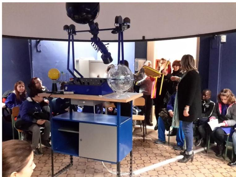
Il planetario è uno strumento scientifico molto sofisticato che si trova nel Liceo dal 2003 e che ci permette di vedere le stelle quando il cielo è coperto o quando la luce del Sole non ci permette di vederle. Si tratta di una cupola in acciaio inox che misura 4 metri circa di diametro e da un proiettore posizionato sotto, costruito dalla ditta Gambato di Verona. Ha lo scopo di mostrare la volta celeste alle varie latitudini, ore del giorno e
